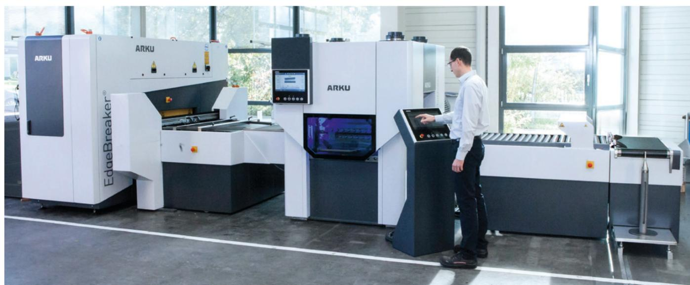
Die Prozesskette im Blick: Entgraten mit dem EdgeBreaker® 2000 Plus, Richten mit dem FlatMaster® 55 80 und die Ebenheitskontrolle mit dem FlatJack® in einer Linie.
