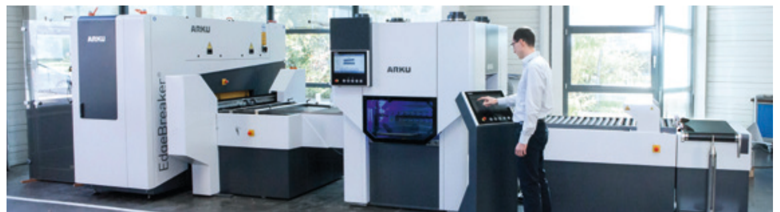
Die Prozesskette im Blick: Entgraten mit dem EdgeBreaker® 2000 Plus, Richten mit dem FlatMaster® 55 80 und die Ebenheitskontrolle mit dem FlatJack® in einer Linie.
