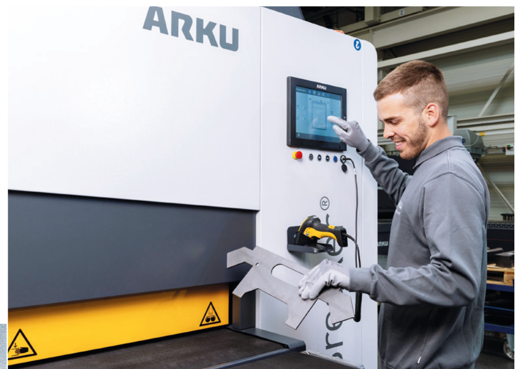
Beidseitige Entgratung und Kantenverrundung für Laserteile in einem Durchgang - der EdgeBreaker® 3000.
