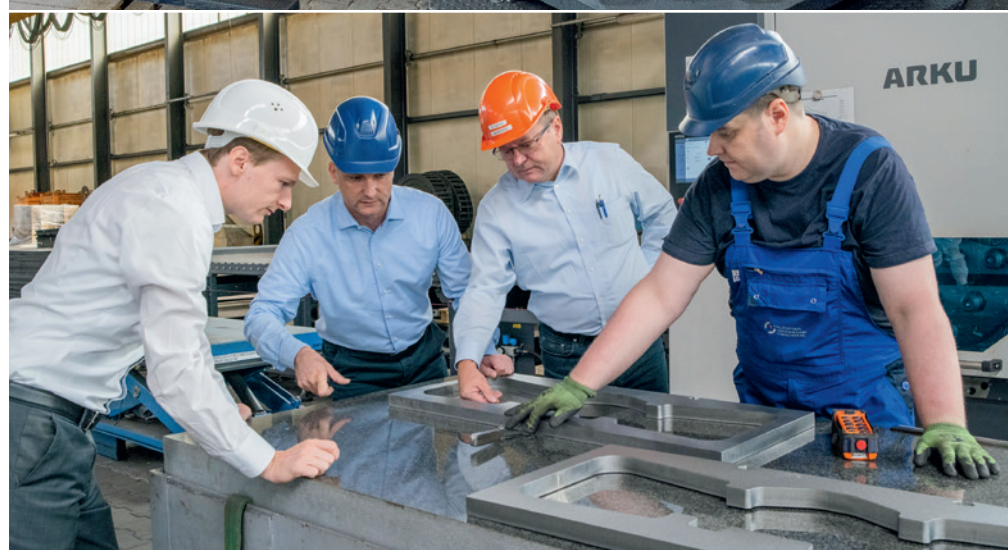
Glatte Tatsachen: v.l.n.r. Christian Nau, Vertrieb bei ARKU, Daniel Götze, Produktmanager Anarbeitung bei SMSD, Norbert Gärtner, Betriebsleiter bei SMSD und Patrick Völpert, Maschinenbediener bei SMSD prüfen die Ebenheit der gerichteten Teile.
