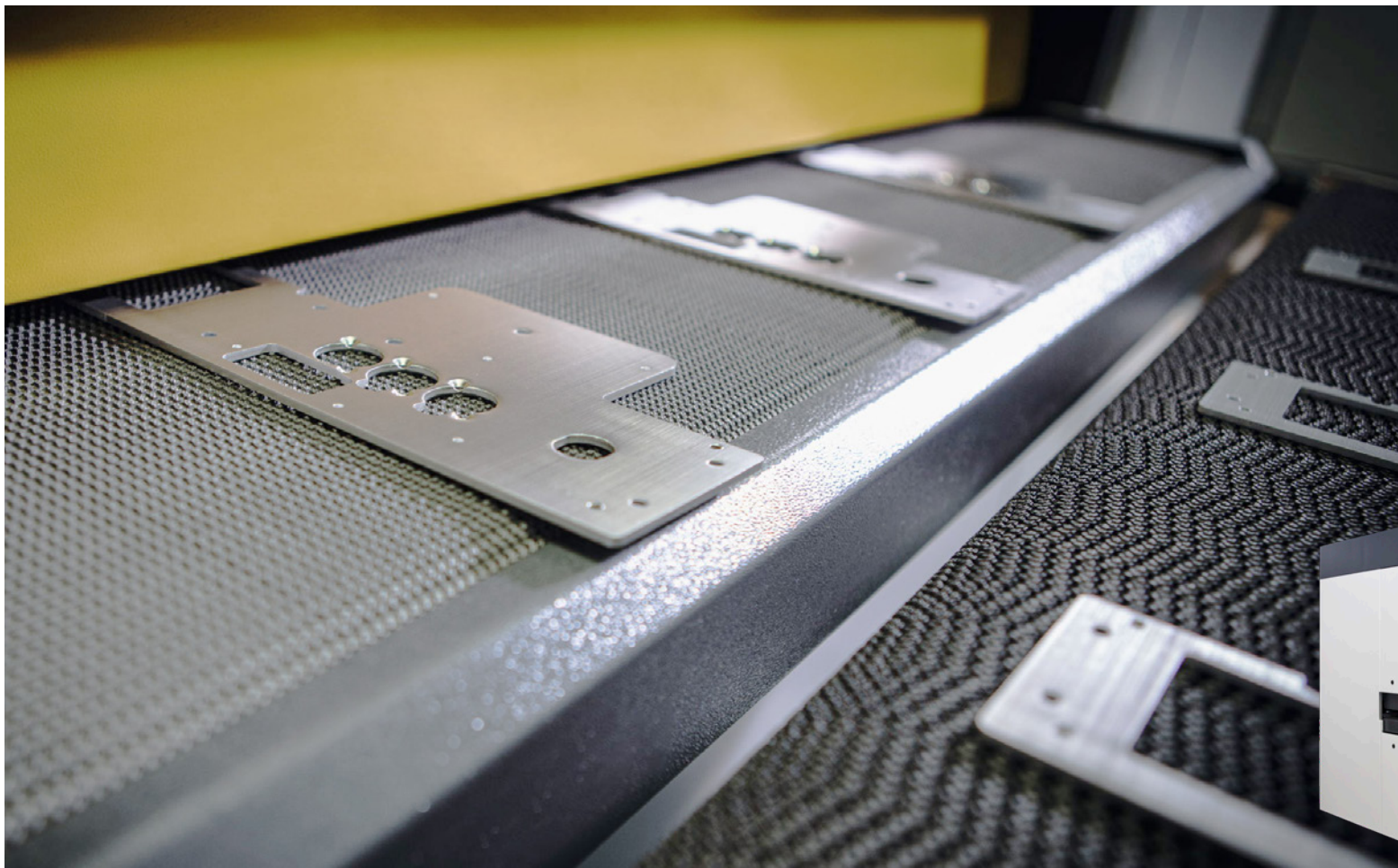
In wenigen Sekunden zum perfekten Blechteil: Der EdgeBreaker® 3000 entgratet beidseitig und spart damit viel Zeit im Vergleich zu einseitig arbeitenden Entgratmaschinen.
