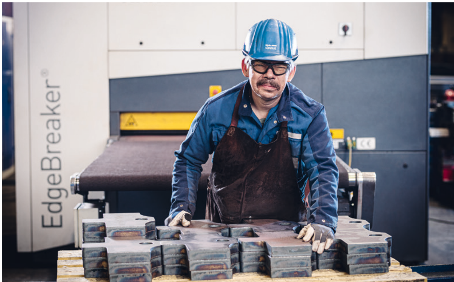
Konstante Qualität statt Plackerei mit Winkelschleifern: Der EdgeBreaker® 4000 hat das Entgraten der Grobbleche beim Stahl-Weiterverarbeitungsspezialisten SÜDSTAHL deutlich vereinfacht. Dabei stieg auch die Produktivität kräftig.
