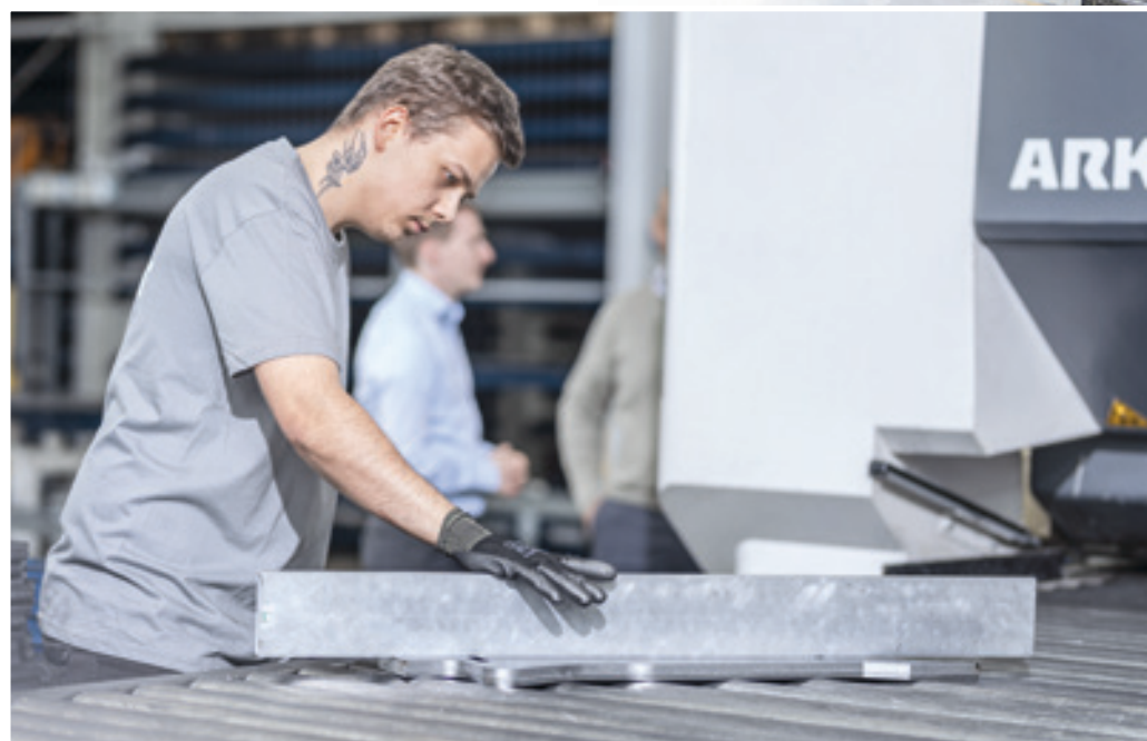
Ist die Ebenheit ausreichend? Petr Müller, Techniker bei HATEC, prüft ein Bauteil nach dem Richten.
