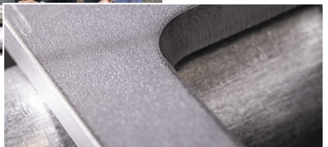
Keine Grate, verrundete Kanten und eben: So lassen sich Blechteile weiterbearbeiten und beschichten.
