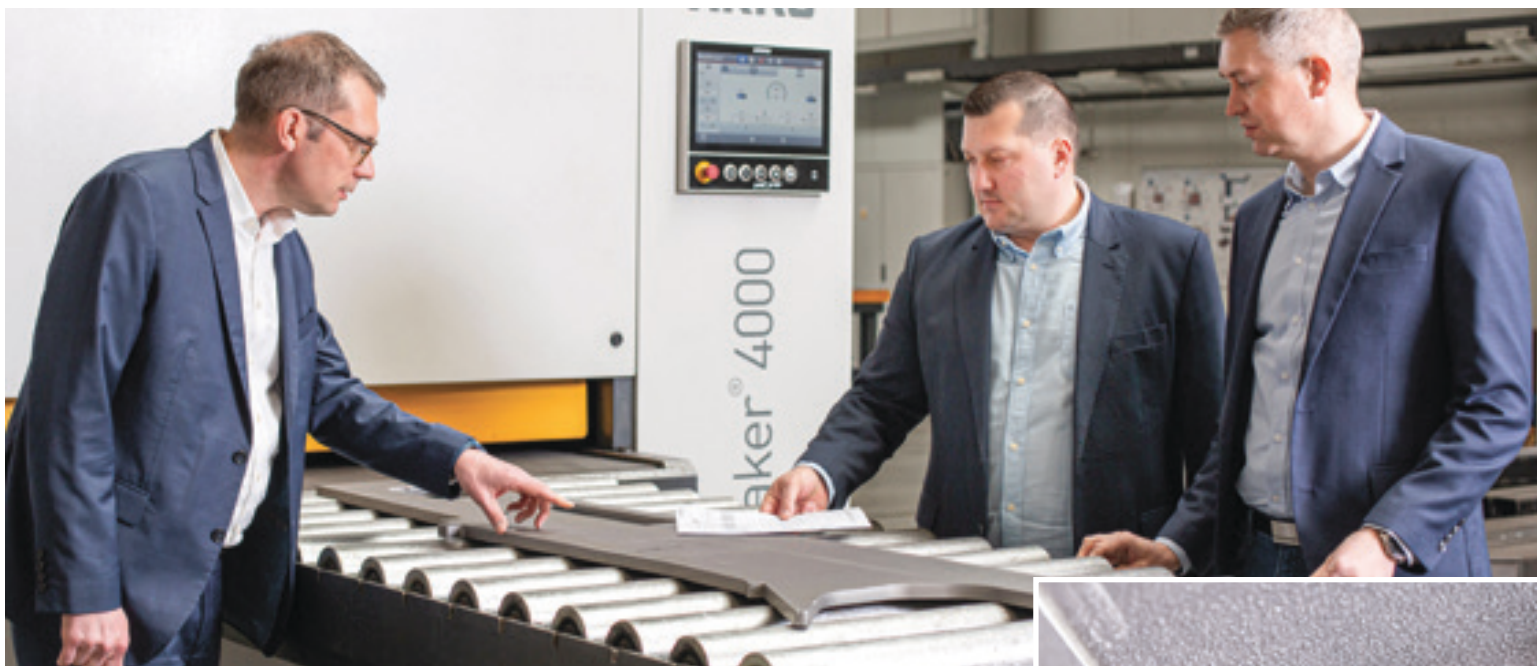
¿Qué tal han quedado los bordes? Raphael Goldbach (izquierda), Ventas de ARKU, Witold Matusiak (centro), Propietario de WIT-METAL, y Andrzej Witczak, Jefe de Diseño e Ingeniería, comprueban el resultado del desbarbado del EdgeBreaker® 4000.
