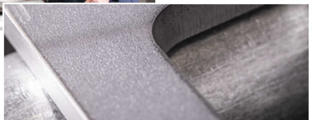
Sin rebabas, con bordes redondeados y planos: así es como se pueden seguir procesando y recubriendo las piezas de chapa.
