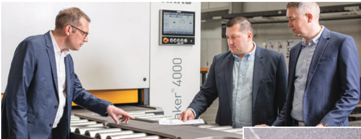
Comment sont les bords ? Raphael Goldbach (à gauche), service commercial ARKU, Witold Matusiak (au centre), propriétaire de WIT-METAL, et Andrzej Witczak, directeur du bureau d'études et de l'ingénierie, vérifient le résultat de l'ébavurage sur l'EdgeBreaker® 4000.
