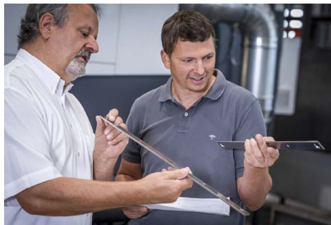
Auch die Aussparungen sind mit dem Edgebreaker 3000 gut entgratet. © Arku Maschinenbau
