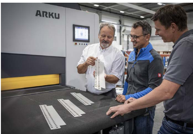
Zudem sorgt die Entgratmaschine für eine gleichmäßige Kantenverrundung © Arku Maschinenbau
