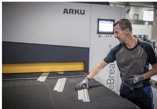
Für die Mitarbeiter bedeutet der Edgebreaker 3000 eine Erleichterung, weil die Maschine in einem Durchlauf die Teile beidseitig entgratet. © Arku Maschinenbau
