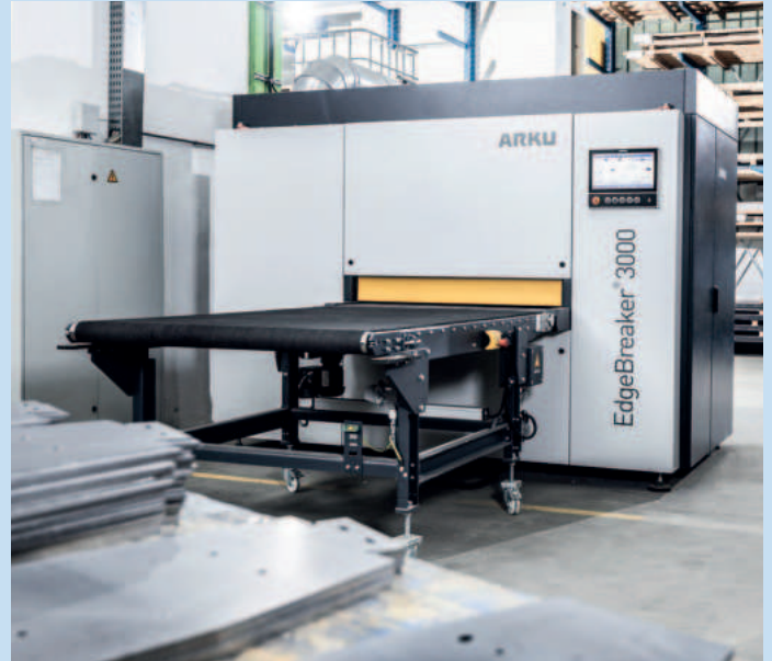
Der EdgeBreaker® 3000 von ARKU sorgt bei Dawo schnell für saubere und verrundete Blechkanten.
