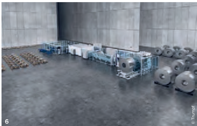
5 Da das Blech auf dem Coil quasi endlos ist, lassen sich die Teile besser verschachteln – der Verschnitt reduziert sich. 6 Die neuen Coil-Laser-Anlagen von Arku und Trumpf machen jetzt Coilware für Laser-Blechbearbeiter interessant.
