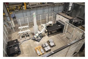
Jede Menge Hightech: Der Roboter legt selbständig die zu verarbeitenden Teile auf, sodass die Arbeitsprozesse vollständig automatisiert ablaufen. (Bild: Liebherr)
