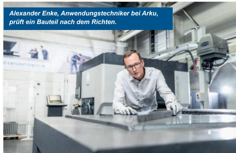
steifer Maschinenrahmen, die richtige Walzenteilung und -abstützung sowie die Anzahl der Richtwalzen.
