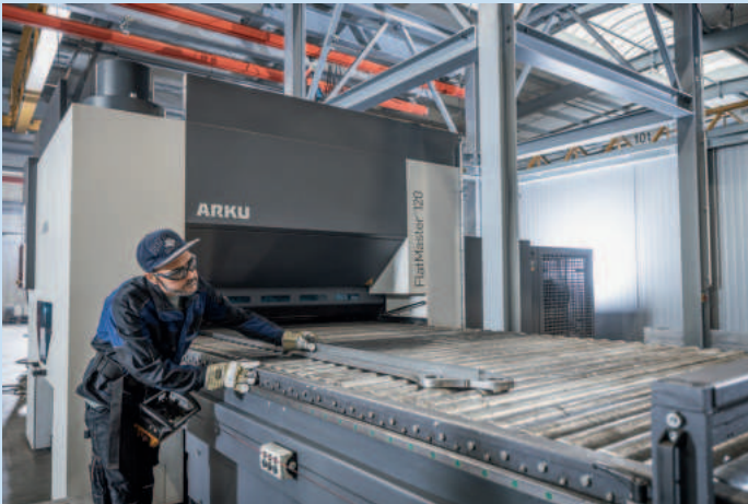
Mithilfe des FlatMaster® 120 kann Heimann mehr Blechteile richten und benötigt dafür weniger Mitarbeiter.
