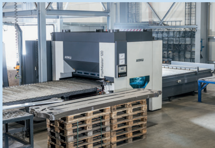
Wettbewerbsvorteil Richtmaschine: Mit dem FlatMaster® 120 kann der Stahlbauer Heimann in Olbernhau die Präzision und Masshaltigkeit seiner Teile und Baugruppen verbessern.
