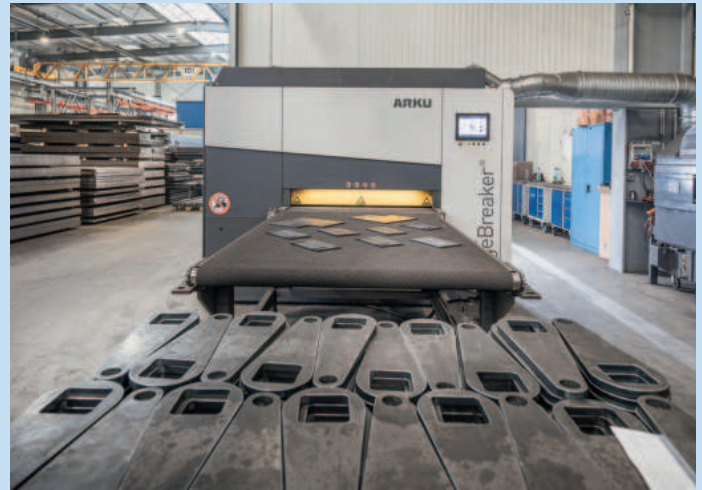
Ebenfalls von Arku ist der EdgeBreaker® 4000 zum Entgraten und Verrunden der Bleche.
