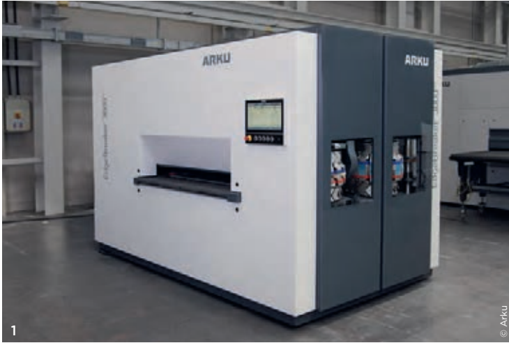
1 Mit dem EdgeBreaker 3000 Next bringt Arku eine neue Generation von Entgratmaschinen für Stanz- und Laserteile auf den Markt. 2 Mit der Richtmaschine FlatMaster 55 werden Blechteile in Sekundenschnelle eben, wie Arku auf der Euroblech zeigen wird.
