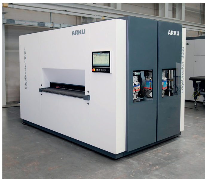
Mit dem EdgeBreaker 3000 Next bringt Arku eine neue Generation von Entgratmaschinen für Stanz- und Laserteile auf den Markt.
