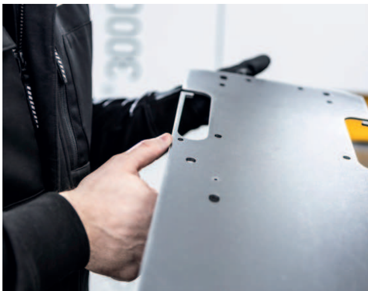
Verrundete Kanten sind bei Laserteilen nicht nur für die Beschichtung wichtig, sie verhindern auch Schnittverletzungen.
