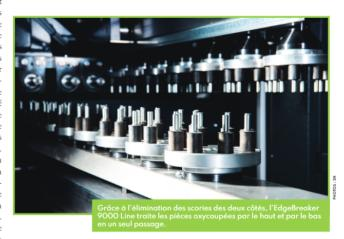
lage grandement l'opérateur. De plus, les temps de passage sont réduits de plus de 50 % grâce à l'enchaînement des trois étapes de travail sur une seule ligne. Comme la machine présentée plus haut, l'EdgeBreaker 9000 Line peut bénéficier de l'assistant de réglage assisté par IA, Arku Wizard, qui permet aux opérateurs des machines d'accéder à des « pouvoirs magiques ». Une solution désormais visible sur presque toutes les machines de planage et d'ébavurage Arku.
