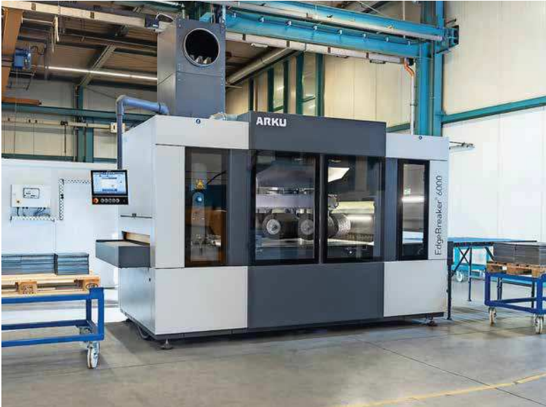
Bei TMS bearbeitet die Entgratmaschine Edge Breaker 6000 von Arku auch dünne Bleche von nur 0,6 mm Stärke.
