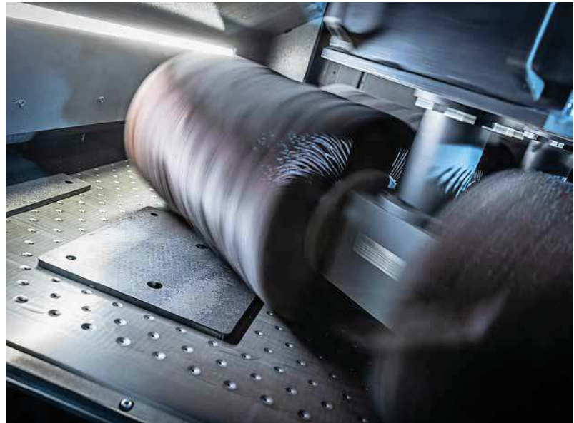
Mit rotierenden Schleifbürsten auf einem Rotor verrundet der Edge Breaker 6000 die Blechkanten besonders gleichmäßig.
