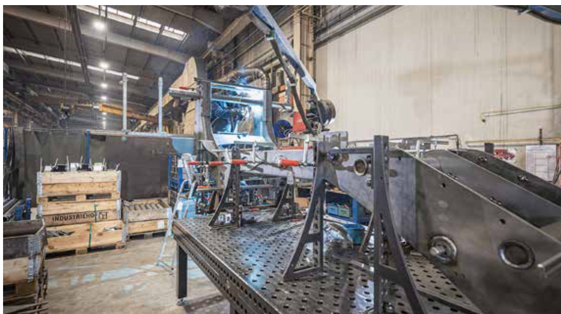
Damit große Bau-gruppen präzise gefügt werden können, müssen die Blechteile genau passen.
