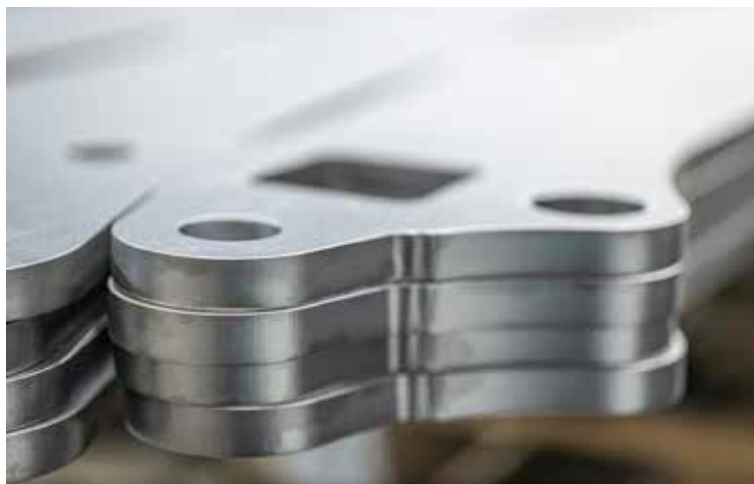
So sehen Blechteile für die präzise Weiterbearbeitung aus: entgratet, ver-rundet und gerichtet.
