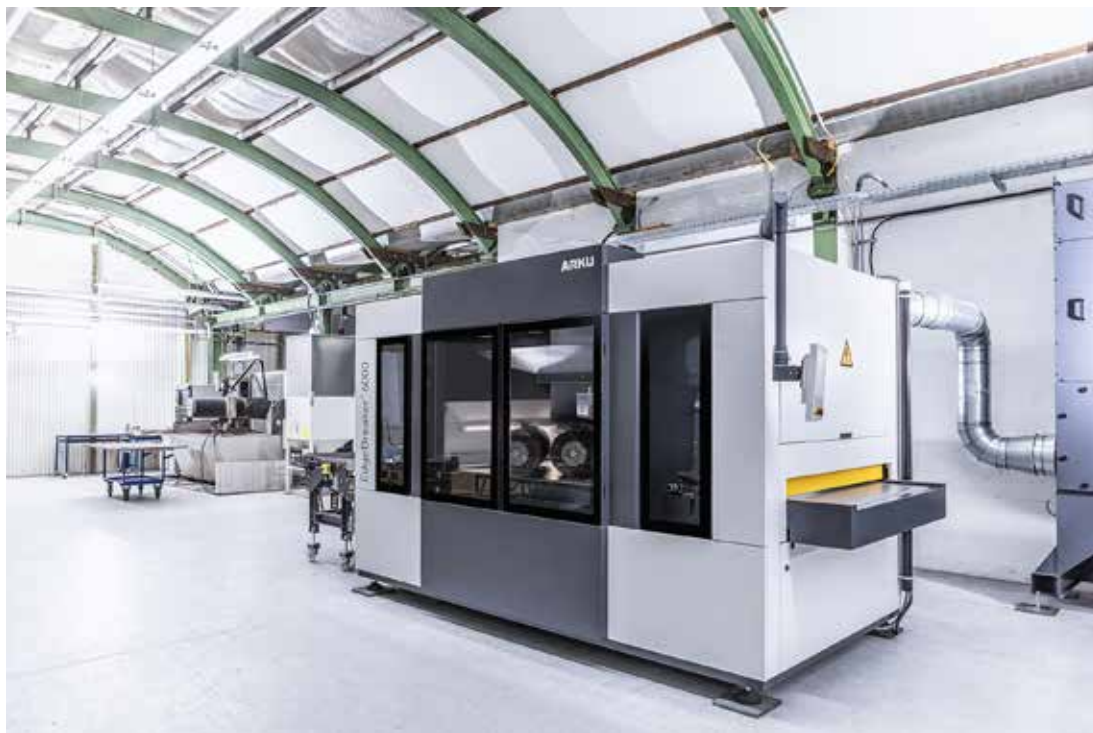
Der EdgeBreaker 6000 übernimmt das entgraten, Blechkanten verrunden und das Oberflächenfinish der Teile.
