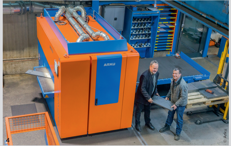
3 Der »Edgebreaker 4000« bearbeitet bei Nägele typischerweise Teile wie dieses mit einer Stärke von 25 Millimetern. Pro Jahr laufen 1.000 Tonnen Stahl über das Band der Entgratmaschine.
