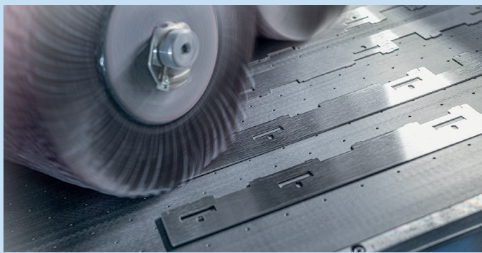
Mit seinen Rotorbürsten sorgt der EdgeBreaker® 6000 für eine besonders gleichmäßige Kantenverrundung.
